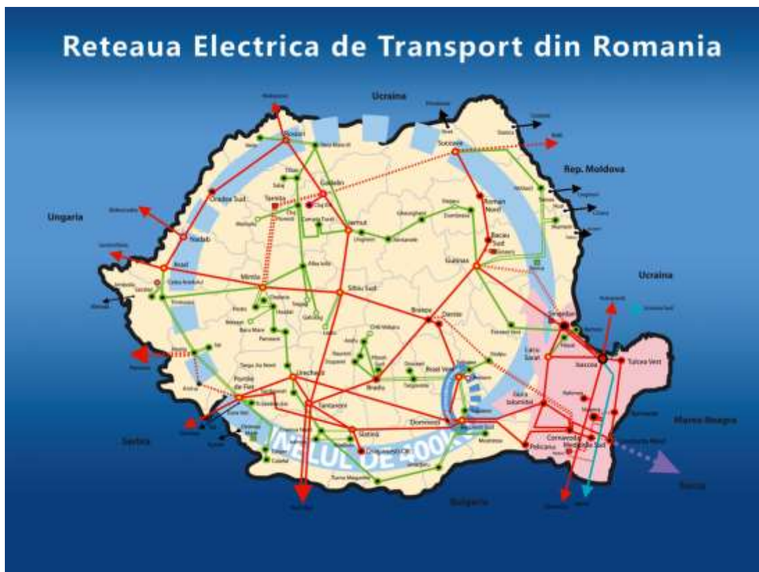
Figura 3: Rețeaua Electrică de Transport
